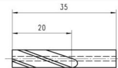
Zylindrischer Fräser Ø6
